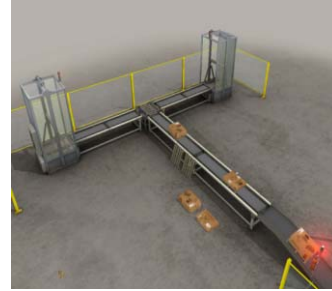
Figure 7 : Système de tri de caisses issu de la collection IST PCLC
