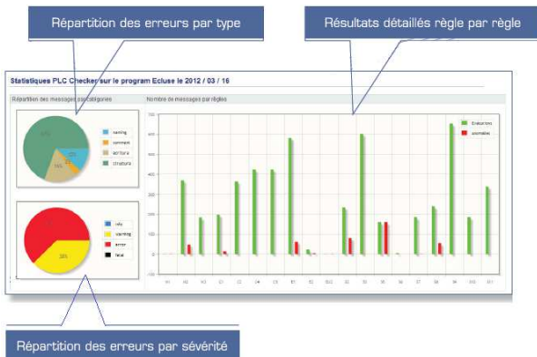
fig 4 : Exemple d'indicateurs graphiques avec PLC Checker
